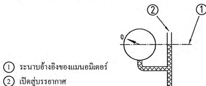
รูปที่ 11 การจัดเตรียมสำหรับการหาระนาบอ้างอิงของเกจความดันแบบสปริง
